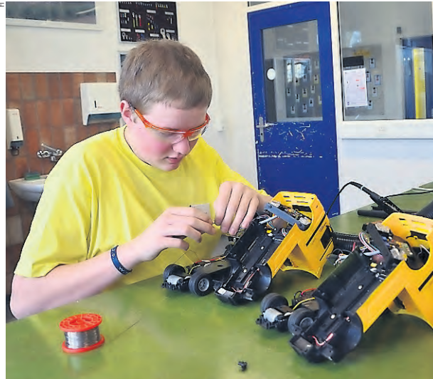
Beispiel einer Auftragsarbeit: ferngesteuerte Spielzeuglastwagen werden modifiziert, damit sie im Rückwärtsgang langsamer fahren.
