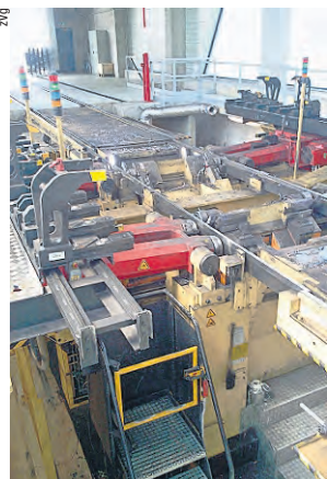
Impianto di riprofilatura tandem.
