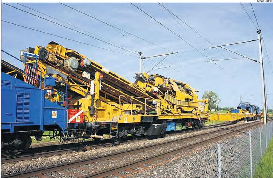
Mit einem 148 Tonnen schweren Bauzug des Typs «Pascal 2» und zwei weiteren Spezialzügen wird gegenwärtig zwischen Uttigen und Thun ein 4,5 km langes Gleisstück ersetzt. Das Manövrieren des Maschinenparks und die Transportlogistik stellen für die SBB eine Herausforderung dar.
