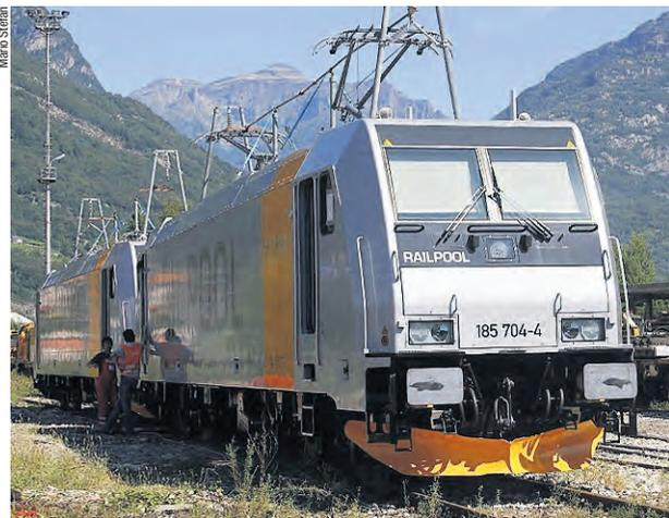
Le due locomotive Railpool 185 704-4 e 705-1 a Domodossola pronte a fornire energia reattiva alla rete da 15 kV in caso di perturbazione alle due sottocentrali mobili di Varzo.
