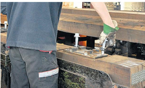
7. An den beiden Einschnitten mit den Bohrlochern werden Schienenhalterungen aus Metall angebracht.
