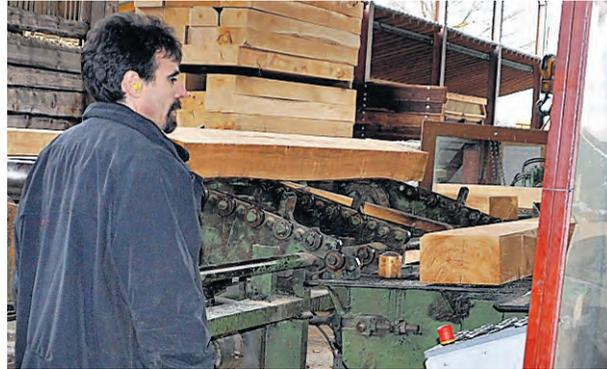
2. Das Frischholz wird für die Standardschwellen auf eine Länge von 2,50 Metern rechtwinklig zugesägt.
