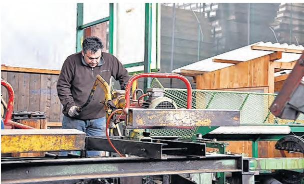
5. Nach dem Trocknen werden die Schwellen eingeschnitten und vorgebohrt (zweimal vier Bohrlocher).
