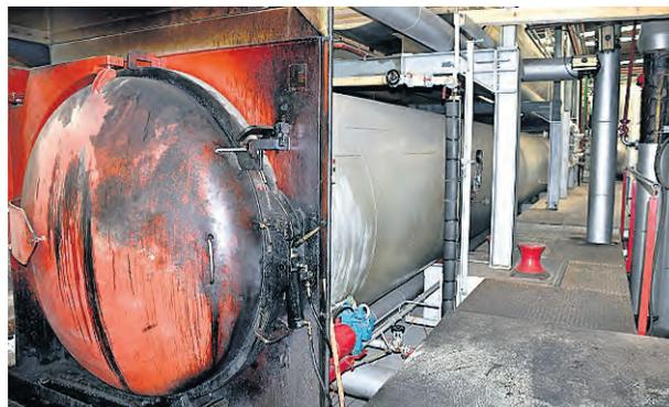
6. In diesem Tank werden die Schwellen mit 120 Grad heissem Kreosotöl (Steinkohlenteeröl) imprägniert und erhalten so eine 30-jährige Lebensdauer.
