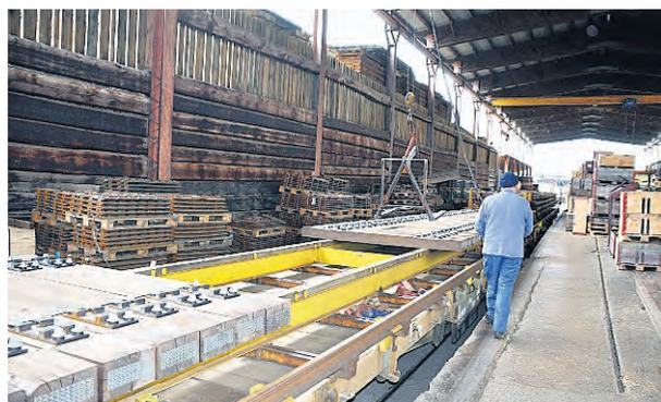
8. Die fertigen, 110 Kilogramm schweren Schwellen werden auf Bahnwagen verladen und zu den Baustellen transportiert.
