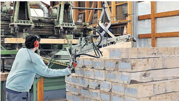
3. Eine Maschine bringt an beiden Enden je eine Metallplatte an, um zu verhindern, dass sich beim Trocknen Risse bilden.
