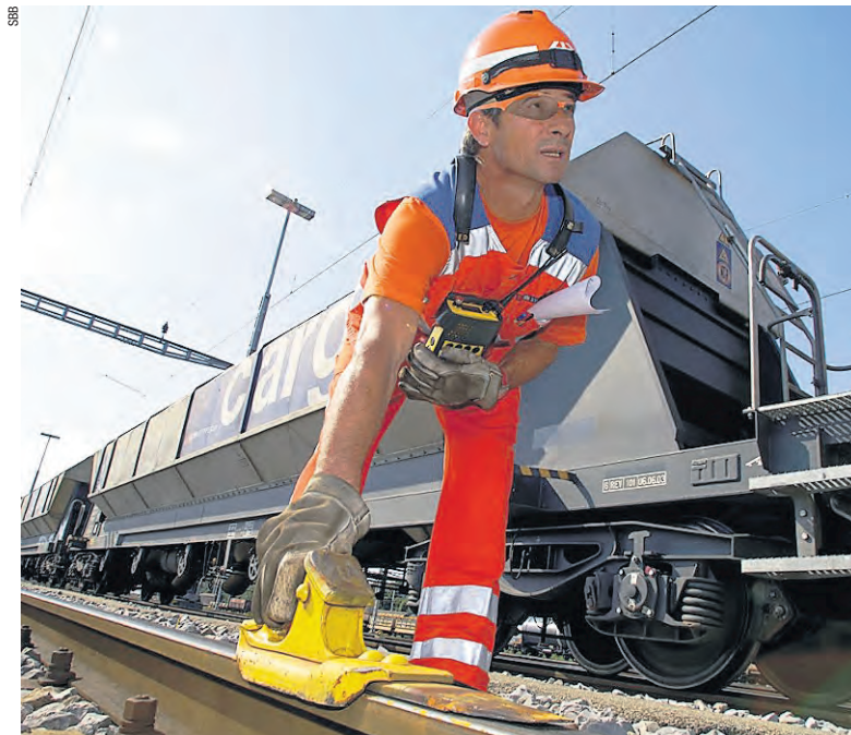
Hemmschuh legen: In modernen Rangierbahnhöfen nicht mehr nötig, da die Wagen automatisch abgebremst werden, wenn sie vom Ablaufberg kommen – und die Arbeit fällt weg.
