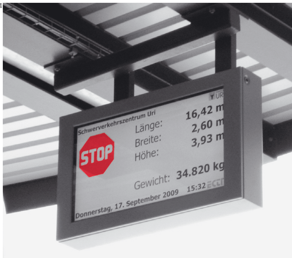
La misurazione automatica dei mezzi pesanti di «Ripsi».
