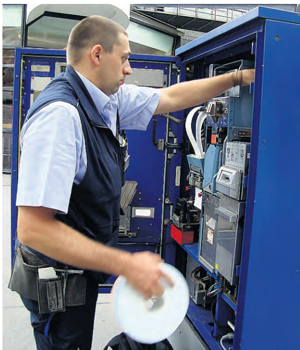
Changement de rouleaux de papier à un distributeur à billets de la ZW.
