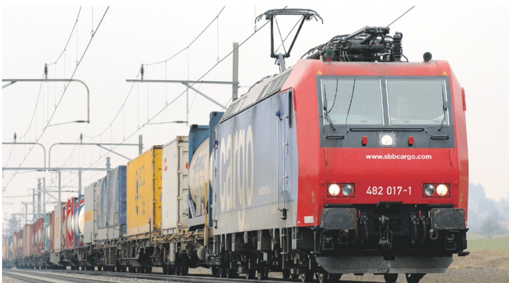
Güterzüge sind heute rund 10 dB(A) leiser als 2003, vor allem dank dem faktischen Verbot der Graugussbremsen. Das entspricht einer Halbierung der wahrgenommenen Lautstärke.
