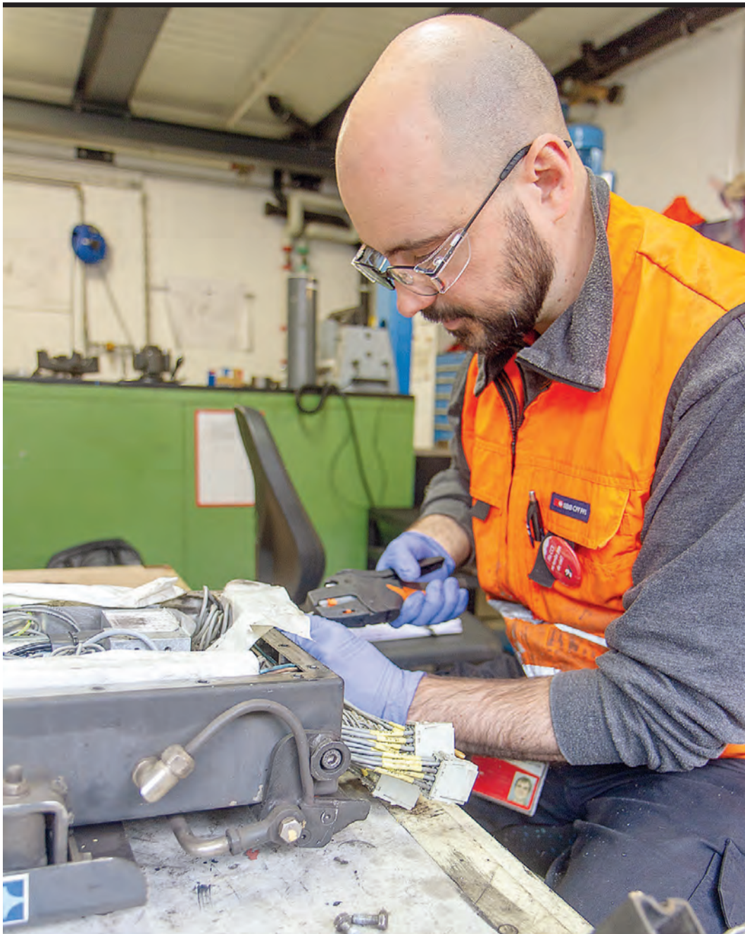
Sylvian Sahli en plein travail de réparation d'une tête électrique Flirt.
