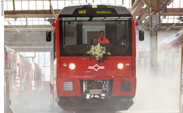
Le SZU a présenté en juin 2013 dans son dépôt une des six rames Stadler Be 510, qui circulent aujourd'hui sur la ligne de Uetliberg (électrifiée en 1200 V continu) et sur la ligne de Sihltal (électrifiée en 15 kV). Les Be 510 sont les premiers engins bicourant du SZU.
