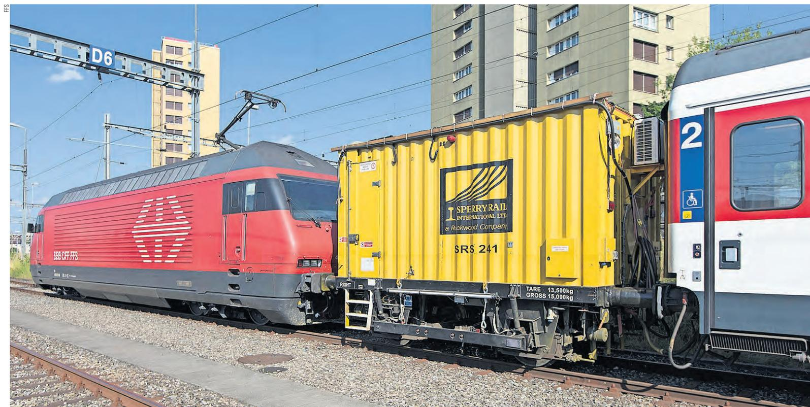
L'impiego del nuovo veicolo di diagnosi delle rotaie SRS 241, dotato di ultrasuoni per rilevare crepe nella rotaia, ha accertato maggiori necessità di manutenzione.
