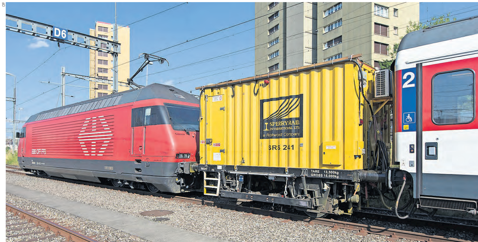
Le tout nouveau train d'auscultation des rails Sperry SRS 241 a permis de constater une hausse des besoins d'entretien.
